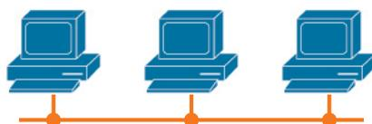
FIGURE 209. Exemple de réseau ethernet 10BASE5.
