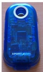
FIGURE 227. Boîtier SI SRR utilisé pour les postes radio.
